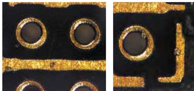
**Рис. 9.** а) Фотографии после теста на сдвиг; б) остаточные следы от бампов
