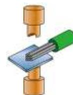
Контактная и ультразвуковая сварка
