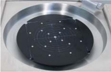
**Установка нанесения фоторезиста Arosee Bake Plate** позволяет обрабатывать пластины диаметром до 200 мм. Опционально доступны различные функции, такие как программируемая настройка зазора между нагревательной плитой и пластиной, автоматическая подстройка зоны нагрева к размеру пластин и продувка рабочей камеры азотом.
