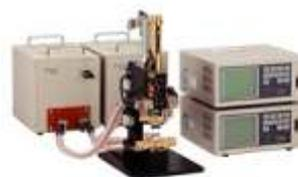
Установка монтажа с верхним и нижним импульсным нагревом
