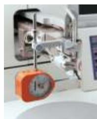
Тестирование проволоки на отрыв
