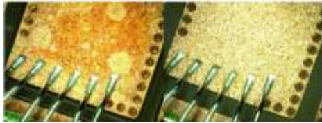
Очистка поверхности перед разваркой проволочных перемычек
