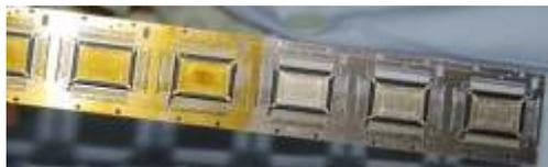
Плазменная обработка медных выводных рамок позволяет удалить оксиды, остатки флюса и другие загрязнители с поверхности.
