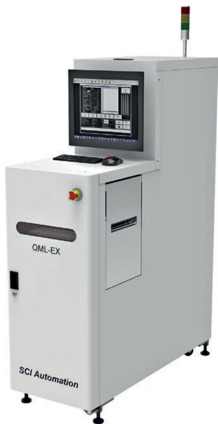
Рис.7. Внешний вид системы плазменной очистки, встраиваемой в автоматическую линию
