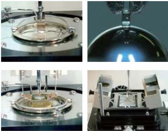
**Установка Rhesca 5200T - это универсальный тестер смачиваемости припоев и флюсов. Модель позволяет проводить тестирование по методу баланса смачивания, по методу припойной капли, по методу быстрого нагрева и по методу температурного профиля. Установка оснащена магнитными захватами образцов, новым электробалансом и контроллером для автоматической калибровки нуля, сенсорным дисплеем для управления и обработки данных. Соответствует международным стандартам качества и безопасности.**
