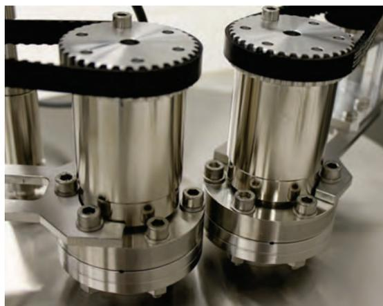
Дополнительное оборудование Picosun для рулонной подачи и обработки гибких материалов идеально подходит для проведения НИОКР в области непрерывного ACO.
