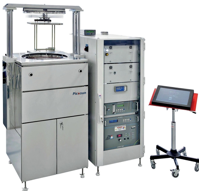
Рис.5. Промышленная установка Picosun P-300B: рабочий модуль с реакционной камерой, блок управления и панель интерфейса с сенсорным экраном (© Picosun Oy)
