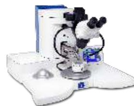
Установка ультразвуковой микросварки
