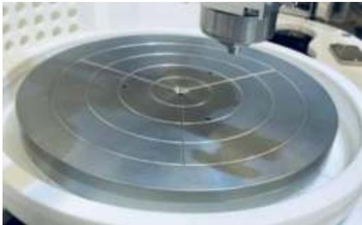
**Установка Osiris UNIXX SP20** предназначена для спрей-нанесения фоторезиста; подходит для подложек диаметром до 200 мм или с размерами до 150x150 мм. Модель разработана для лабораторных применений и небольших серийных производств. Установка UNIXX SP20 имеет программируемое перемещение ультразвукового сопла по осям X и Y, регулировку высоты сопла, автоматическую смену насадки. Дозирование материала задается в технологической программе.
