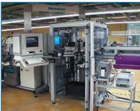
Рис. 3. Специализированная обрабатывающая линия Metzner для заготовки кабельных жгутов
