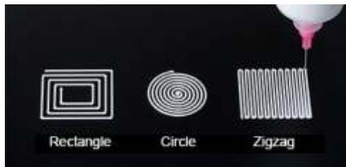
**Дозирующий робот Janome JC-3 с пневматической системой ТАЕНА ТНЕ-200 представляет собой качественное и эффективное решение в области точного дозирования. По заданной программе робот может наносить такие материалы, как паяльные пасты, клеи различных типов, герметики и компаунды, флюсы и пр. Точная конфигурация дозирующей системы выбирается исходя из требуемой производительности, объемов дозирования, типа материала.**
