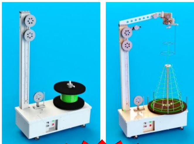
**Размотчик для катушек и размотчик для бухт в одном устройстве!
