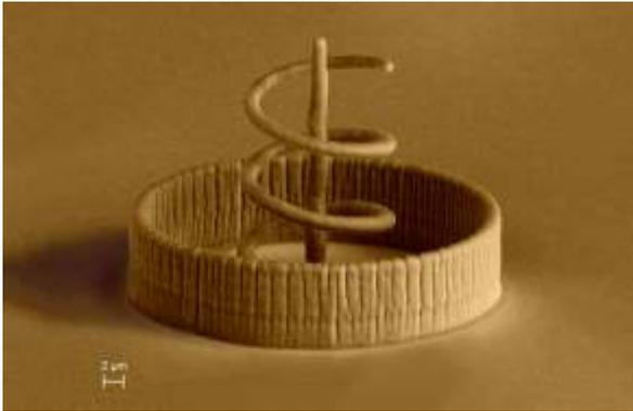
**Микро-3D-принтер Exaddon CERES предназначен для создания структур произвольной формы в микромасштабе, дозирования сверхмалых объемов жидкостей, наночастиц и локальной модификации поверхности. Метод печати, основанный на электролитическом осаждении нано-порошковых материалов, позволяет работать с различными металлами.**
