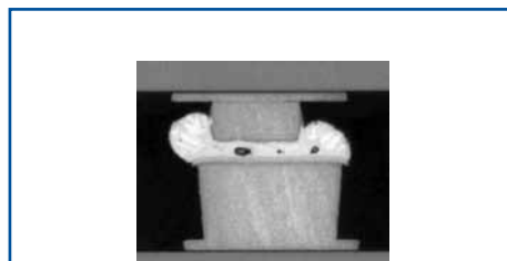
Рис. 5. Небольшие пустоты внутри припоя
