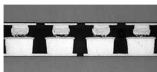
Рис. 1. Поперечное сечение сборки с применением NCF (усилие прижима 500 Н)
