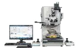
Установки тестирования проволочных соединений
