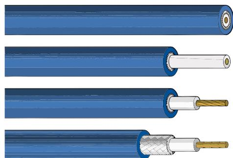
Пример трехступенчатой зачистки
