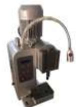
Установка опрессовки проводов наконечниками
