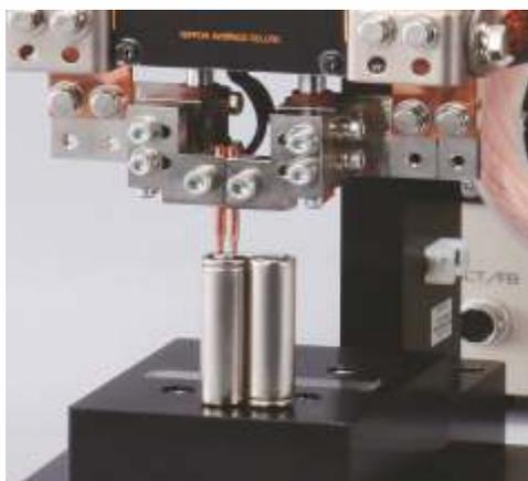
**Установка NRW-DC150 с конденсаторным источником тока применяется для сварки изделий из алюминия, меди и других металлов с высокой теплопроводностью. Оснащена функцией двойного импульса для повышения качества получаемых сварных соединений.**
