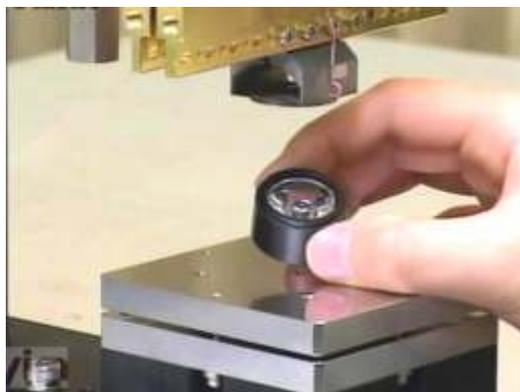
**Установка AVIO NCU-10U/Т/Н предназначена для оплавления пластиковых выводов. Прецизионный температурный контроль с обратной связью позволяет снизить риск растекания пластика или образования трещин. Процесс включает в себя этап охлаждения и заканчивается при полном отверждении пластика, что исключает вероятность прилипания пластика к инструменту и вытягивания «нитей».**
