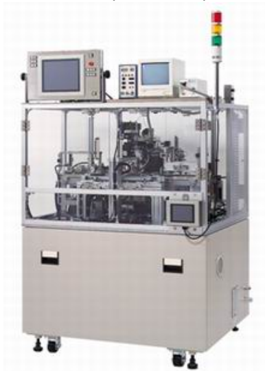
Укладка и прихватка крышек
