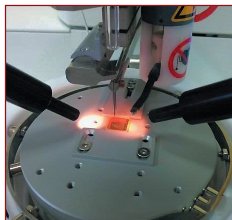
Рис. 9. Образец помещен на рабочий нагреваемый столик установки ТРТ НВ16
