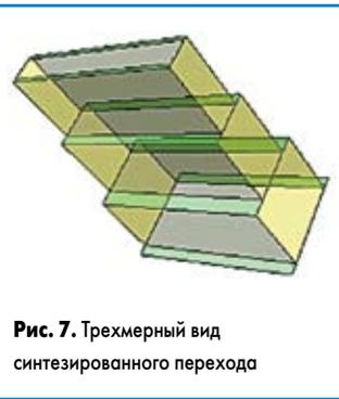
Рис. 7. Трехмерный вид синтезированного перехода
