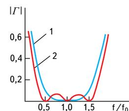
Рис. 3. Частотные характеристики биномиального (1) и чебышевского ступенчатого перехода (2)
