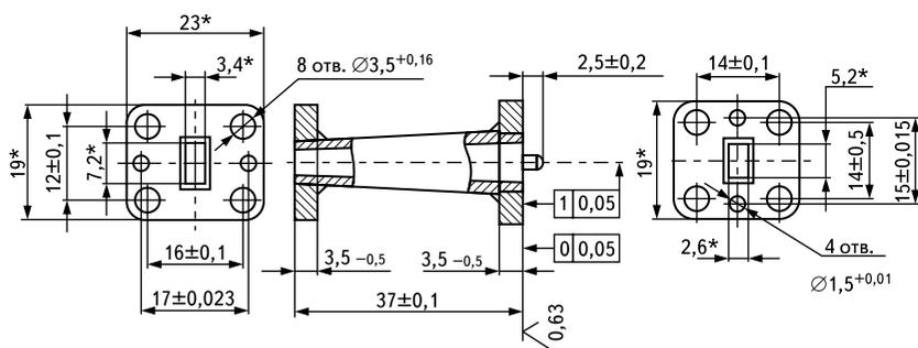
Рис. 1. Конструкция перехода между волноводами различных сечений
