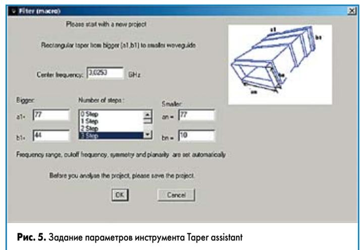
Рис. 5. Задание параметров инструмента Taper assistant
